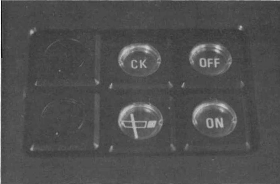
Figura 3.65 b. - Pannello di comando con tasti ON-OFF (acceso-spento) e lampade spia (a sinistra).
